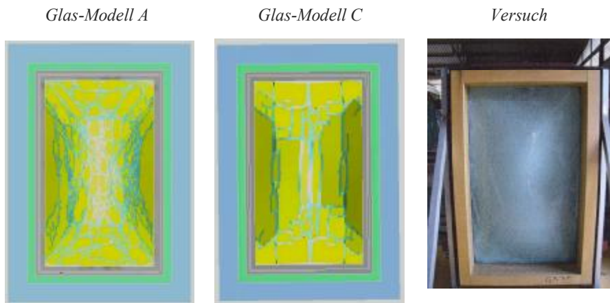
Abb. 9: Rissbilder nach Simulation und Versuch
