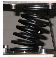
(a) Reale Feder unter Querlast
