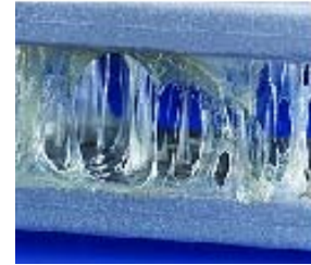
Abb. 1: Fibrillation in aufreissender Klebschicht (Fraunhofer IFAM)
