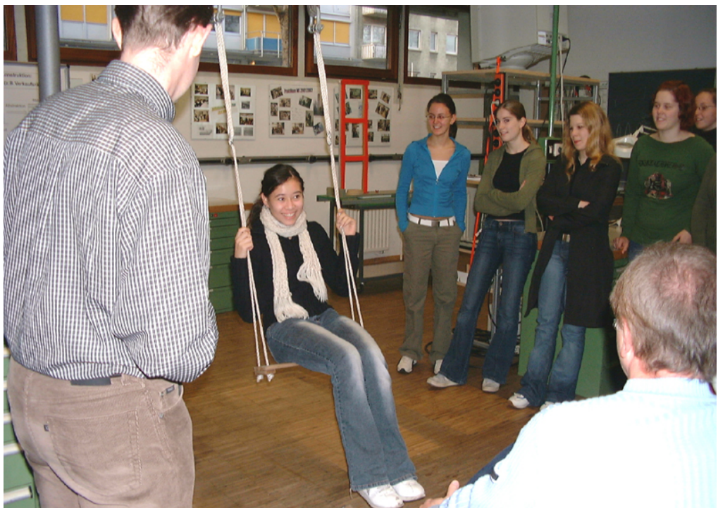
Schaukelversuch zur Veranschaulichung des Begriffs der Eigenfrequenz
