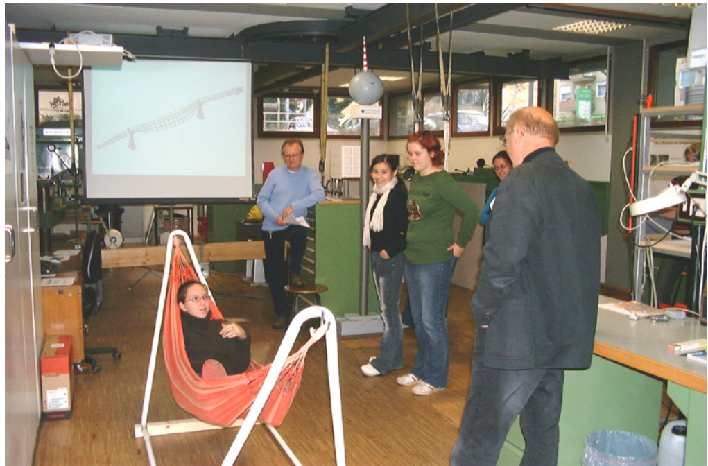
Veranschaulichung der Schwingungsform der Millennium-Bridge anhand der Schwingungen einer Hängematte
