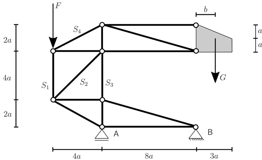
Das dargestellte Tragwerk besteht aus 14 Stäben und einer starren Scheibe. Es wird durch die Kraft  $F$  und durch die Gewichtskraft  $G$  (im Schwerpunkt der starren Scheibe) belastet.
