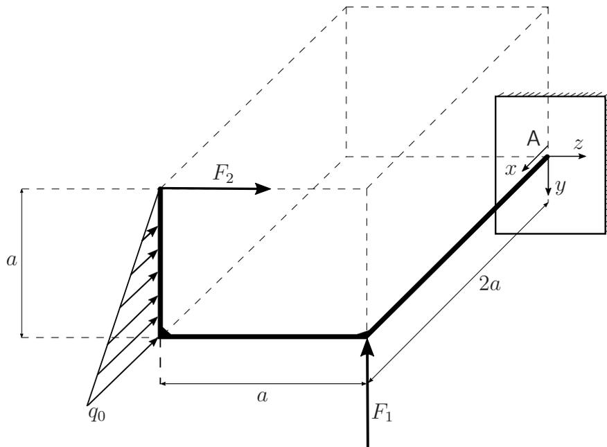
Ein abgewinkelter Träger ist in A eingespannt und wird durch die Einzelkräfte  $F_1$  und  $F_2$  sowie eine dreiecksförmige Streckenlast belastet.
