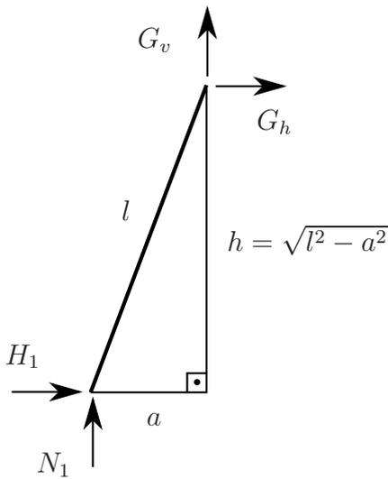
$$\begin{aligned} \Sigma M^G = 0 &: -a \cdot N_1 + h \cdot H_1 = 0 \\ \Rightarrow a \cdot N_1 &= h \cdot H_1 \leq h\mu_0 N_1 \\ \Rightarrow \mu_0 h &\geq a \text{ bzw. } \frac{a}{h} \leq \mu_0 \end{aligned}$$
