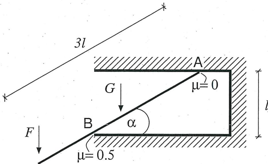
Ein homogener Stab liegt in einer Hülse an zwei Punkten A und B an. Außer der Gewichtskraft  $G$  wirkt die Kraft  $F$  auf den Stab. In Punkt B reibt dieser ( $\mu = 0.5$ ) während er in Punkt A ( $\mu = 0$ ) reibungsfrei gleiten kann.
