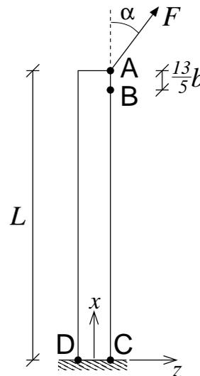
Ein Ankermast mit dünnwandigem elliptischem Querschnitt ( $t \ll a, b$ ) wird außermittig am Punkt A durch eine Kraft  $F$  in der  $x$ - $z$ -Ebene belastet. Bei der Bemessung gilt  $b = \frac{2}{3}a$  und  $L = 24a$ .
