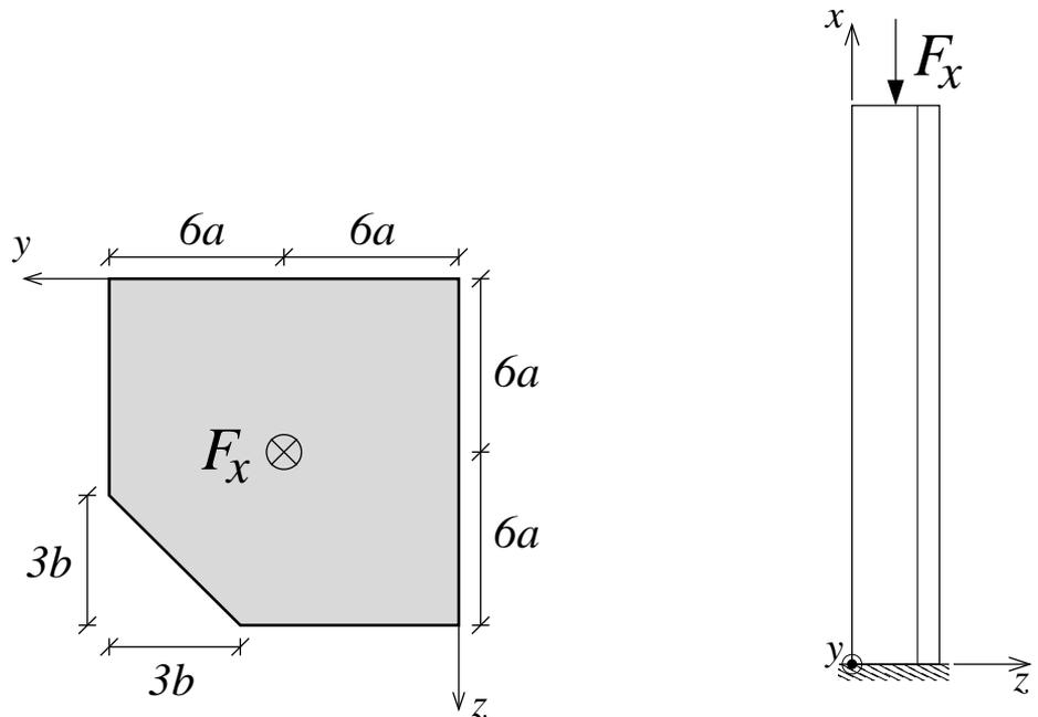
Gegeben ist der abgebildete Querschnitt unter der exzentrischen Druckbelastung  $F_x$ .
