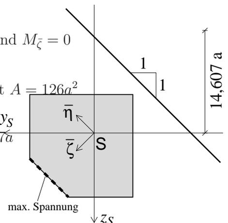
f) aus Aufgabenteil e) ergibt sich die größte Normalspannung an der Stelle des größten Abstands zur Spannungsnulllinie innerhalb des Querschnitts (siehe Skizze).
