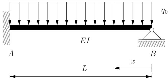
Der dargestellte Träger ( $EI = \text{konst.}$ ) wird durch eine konstante Streckenlast  $q_0$  belastet. Bestimmen Sie unter Verwendung des Prinzips der virtuellen Kräfte (PdvK)
