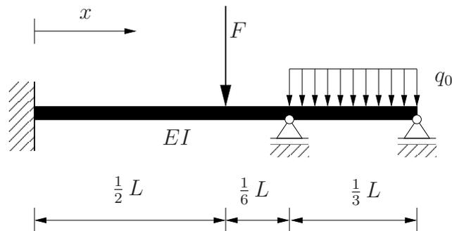
Der dargestellte Balken ( $EI = \text{konst.}$ ) der Länge  $L$  wird durch eine konstante Streckenlast  $q_0$  und eine Einzelast  $F$  belastet.
