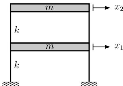
$$\begin{bmatrix} m & 0 \\ 0 & m \end{bmatrix} \begin{bmatrix} \ddot{x}_1 \\ \ddot{x}_2 \end{bmatrix} + \begin{bmatrix} 2k & -k \\ -k & k \end{bmatrix} \begin{bmatrix} x_1 \\ x_2 \end{bmatrix} = \mathbf{0}$$
