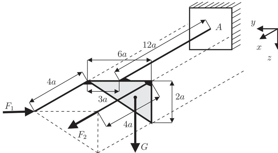
Das dargestellte Tragwerk ist in  $A$  eingespannt und wird durch die Einzelkräfte  $\mathbf{F}_1 = -F_1 \mathbf{e}_y$ ,  $\mathbf{F}_2 = F_2 \mathbf{e}_x$  sowie durch das Eigengewicht der Scheibe  $G$  (homogene Dreiecksscheibe mit konstanter Dicke) belastet. Bestimmen Sie alle Lagerreaktionen in  $A$ .
