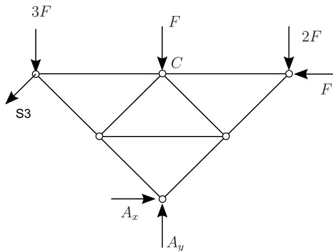
b) Berechnung der Stabkräfte  $S_1, S_2, S_3$
