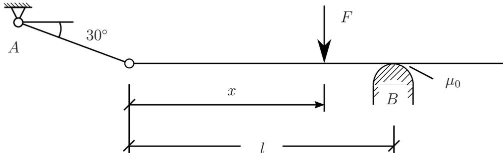
Ein horizontaler gewichtsloser Balken wird in  $A$  über eine Pendelstütze gelagert und liegt in  $B$  lose auf einer rauhen Unterlage (Haftkoeffizient  $\mu_0$ ). In welchem Bereich  $x_{\min} \leq x \leq x_{\max}$  muss die lotrechte Kraft  $F$  angreifen, damit der Balken in der gezeichneten Lage im Gleichgewicht ist, also in  $B$  weder nach rechts noch nach links gleitet?
