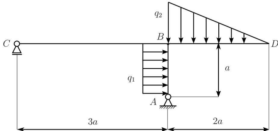
Die dargestellte Konstruktion wird durch die Streckenlasten  $q_1$  und  $q_2$  belastet.
