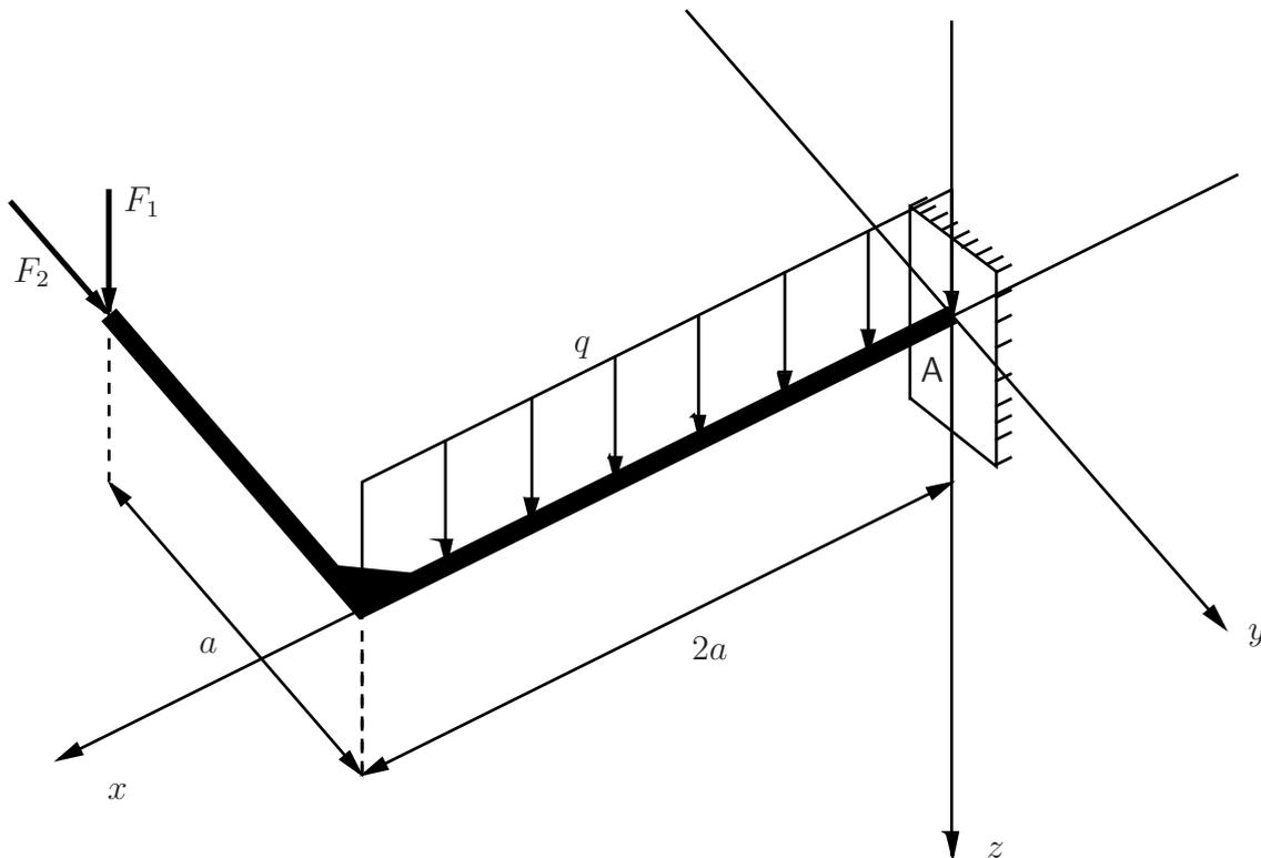
Ein abgewinkelter Träger wird durch die Einzelkräfte  $F_1$  und  $F_2$  sowie eine konstante Streckenlast belastet. Bestimmen Sie die Lagerreaktionen in A.
