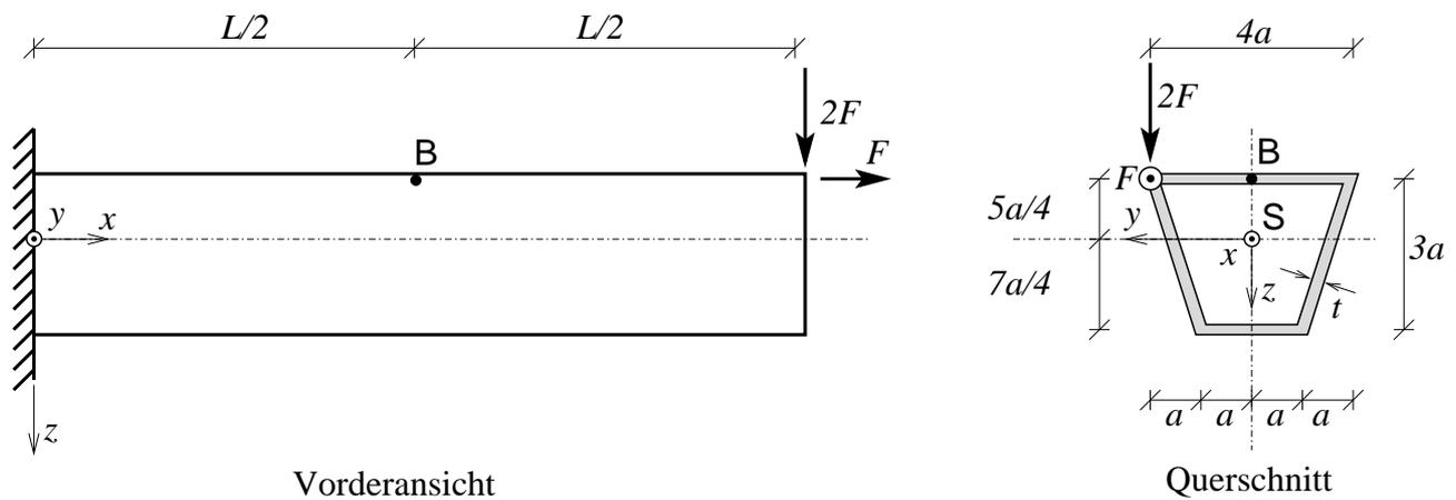
Gegeben ist der im Bild dargestellte Kragträger mit trapezförmigem Hohlkastenquerschnitt mit der Wanddicke  $t$  ( $t \ll a$ ). Der Träger wird durch die exzentrisch angreifenden Einzellasten  $F$  und  $2F$  belastet.
