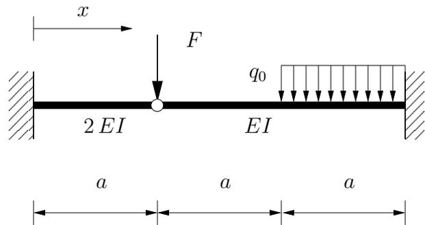
Das dargestellte Balkensystem ( $EI = konst.$ ) wird durch eine konstante Streckenlast  $q_0$  und eine Einzelast  $F$  belastet.
