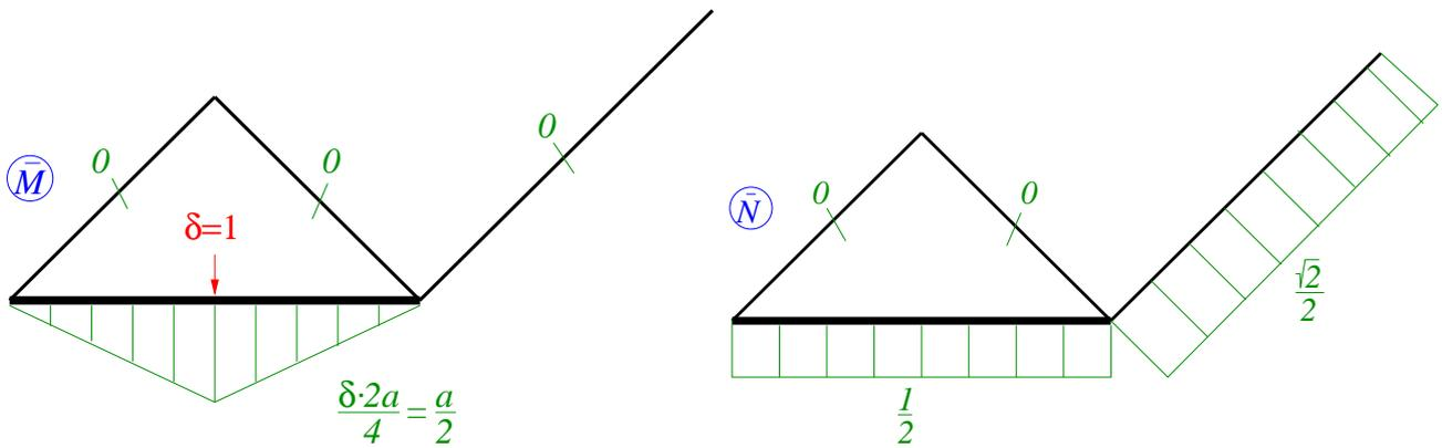
Schnittgrößenverläufe, System mit „1“-Last (ohne äußere Last)
