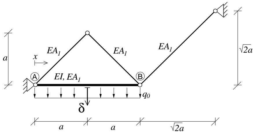
Die dargestellte Tragkonstruktion wird durch eine konstante Streckenlast  $q_0$  belastet.
