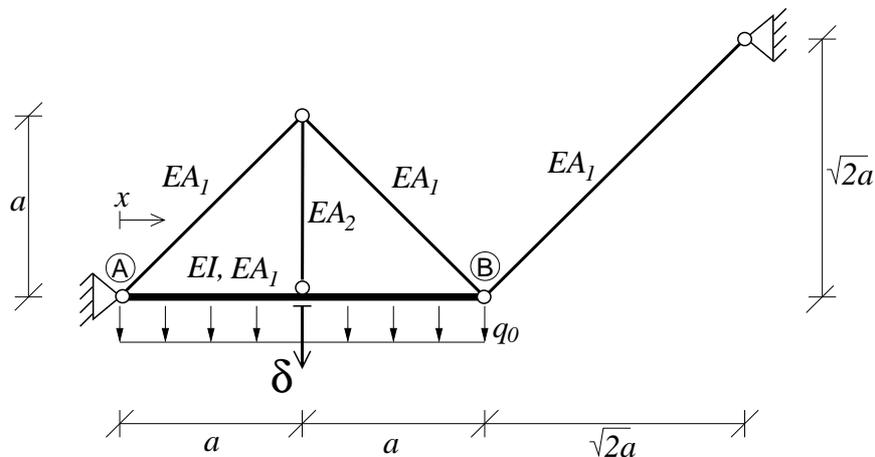
Zur Verminderung der Verschiebung  $\delta$  soll ein zusätzlicher Stab mit der Dehnsteifigkeit  $EA_2$  in die Konstruktion eingebaut werden.
