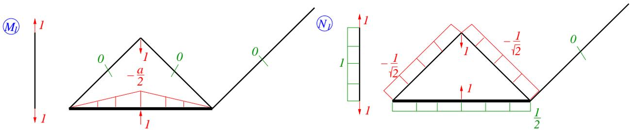
Schnittgrößenverläufe, System mit gelöstem Stab, Stabkraft  $X$  Unbekannte
