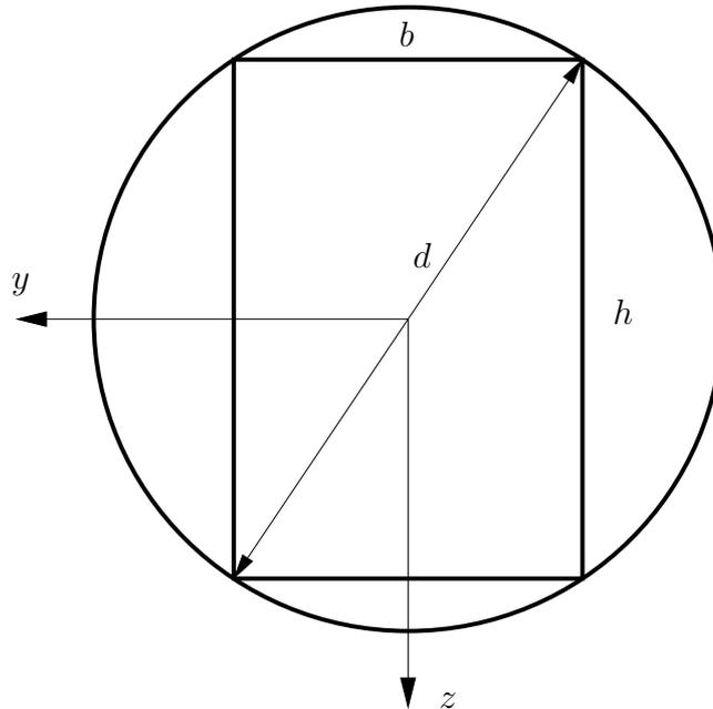
Aus einem Baumstamm vom Durchmesser  $d$  soll ein Balken mit rechteckigem Querschnitt derart herausgesägt werden, dass das Flächenträgheitsmoment bezüglich der  $y$ -Achse ein Maximum annimmt ( $I_{y,max}$ ). Wie groß muss dann  $h$  werden und wie groß ist dann  $I_{y,max}$ ?
