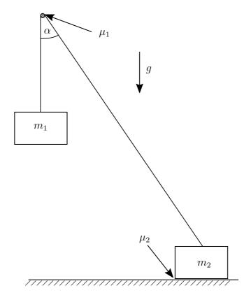
Zwei Massen  $m_1$  und  $m_2$  sind wie skizziert durch ein Seil verbunden. Das Seil wird dabei an einem starren Lager mit Kreisquerschnitt und Haftbeiwert  $\mu_1$  umgelenkt.
