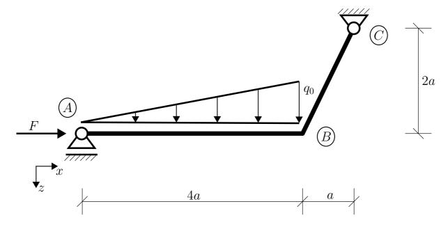
Für das dargestellte Tragwerk unter der linear veränderlichen Streckenlast q(x) sowie der Einzelkraft F sind die folgenden Aufgabenteile zu bearbeiten:
