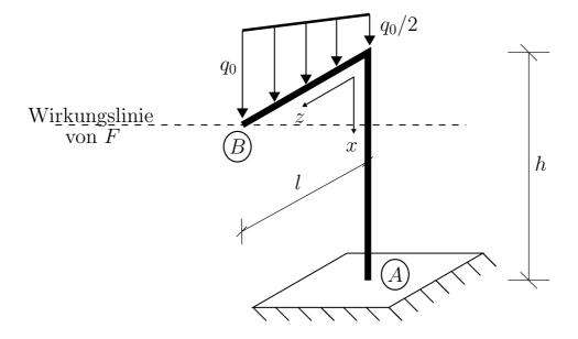
Ein im Punkt A eingespannter Rahmen sei durch eine trapezförmige Streckenlast (siehe Skizze) sowie eine im Punkt B angreifende und in positiver y-Richtung (Rechtssystem!) wirkende Kraft F belastet.
