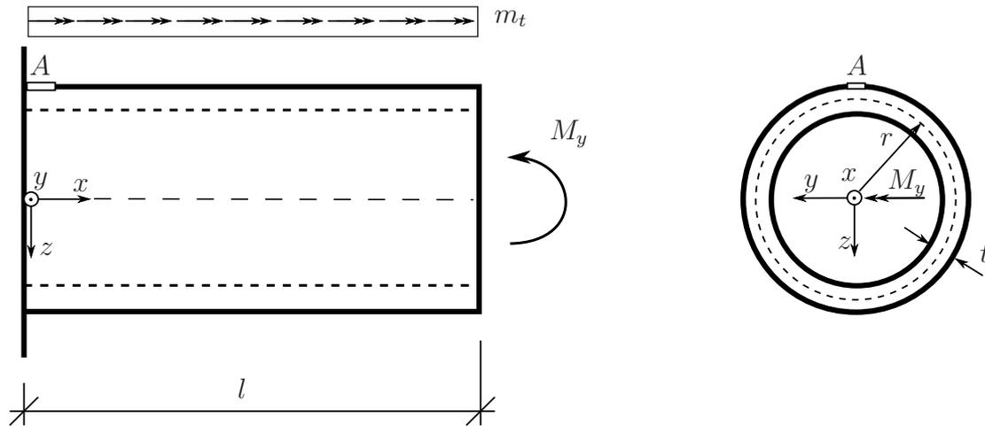
Ein einseitig eingespanntes dünnwandiges Rohr mit mittlerem Radius  $r$ , Wandstärke  $t$  und Länge  $l$  wird am freien Ende mit einem Biegemoment  $M_y$  belastet. Zusätzlich wird der Kragarm mit einem über die Länge  $l$  konstant verteilten Torsionsmoment  $m_t$  belastet.
