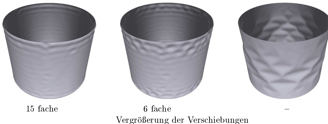
Bild 9: Zylinder 1100–AW, konstanter Innendruck und Axiallast: Last–Verschiebungsdiagramm und Deformationsbilder
