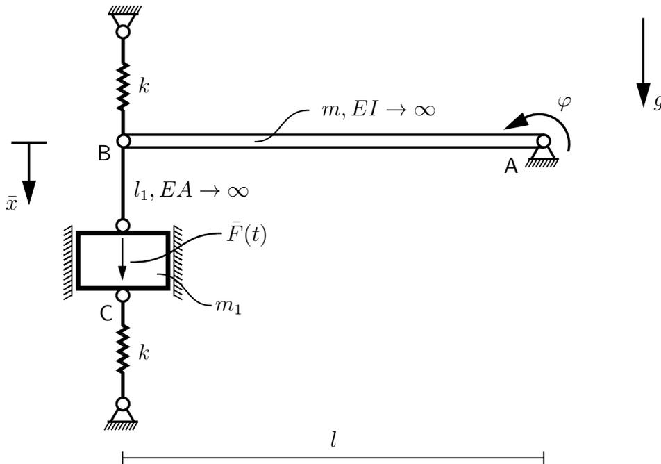
Der in Punkt A drehbar gelagerte, starre Balken der Länge  $l$  sei über einen starren, masselosen, vertikalen Stab der Länge  $l_1$  in Punkt B mit der Punktmasse  $m_1$  verbunden. In den Punkten B und C sind zwei Federn der Federsteifigkeit  $k$  angeschlossen. Auf die Punktmasse  $m_1$  wirkt zudem die zeitabhängige Belastung
