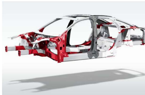
Bild 1: Einsatz von Druckgussbauteilen im Audi A8 (rot markiert)
