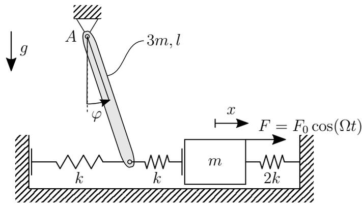
Gegeben:  $m$ ,  $M_{\text{Stab}} = 3m$ ,  $L_{\text{Stab}} = l$ ,  $g$ ,  $k$ ,  $J_{\text{Stab}}^A$ ,  $F = F_0 \cos(\Omega t)$
