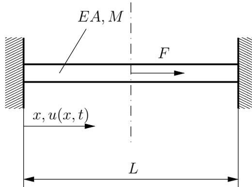
Der abgebildete Dehnstab (Gesamtmasse  $M$ , Länge  $L$ , Dehnsteifigkeit  $EA$ ) ist an beiden Enden fest eingespannt und wird in der Mitte mit der konstanten Kraft  $F$  belastet. Die Erdbeschleunigung kann vernachlässigt werden.
