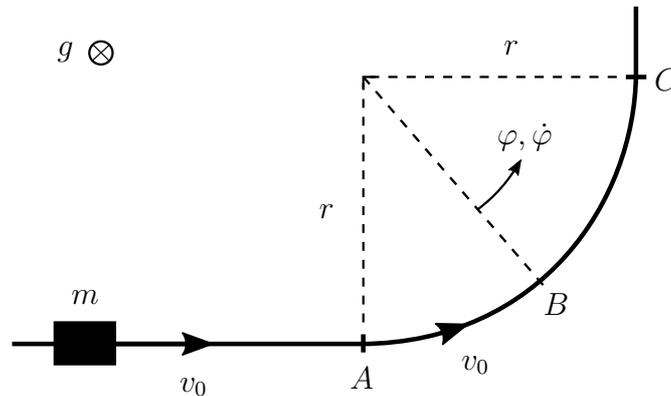
Ein Fahrzeug der Masse  $m$  bewegt sich zunächst geradlinig mit der Geschwindigkeit  $v_0$ . Das Fahrzeug wird als Massepunkt betrachtet. Der Haftreibungskoeffizient zwischen Fahrzeug und Fahrbahn ist  $\mu$ .
