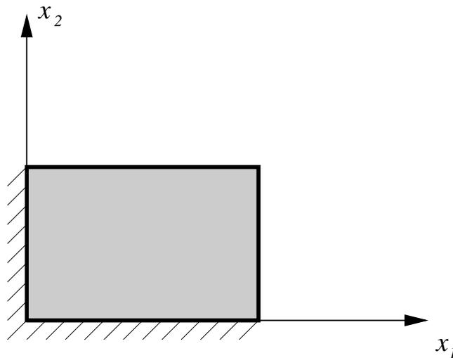
Eine längs der  $x_1$ - und  $x_2$ -Achse fest eingespannte Rechteckscheibe sei durch das Aufbringen einer äußeren Last in der  $x_1, x_2$ -Ebene beansprucht. Auf der Basis von Messungen werden für die Verzerrungen folgende Ansätze vorgeschlagen:
