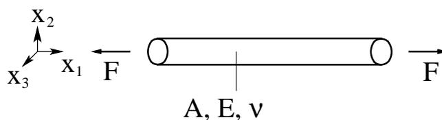
Der dargestellte Stab sei durch die Kraft  $F$  belastet.
