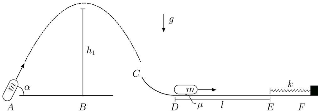
Ein Klotz der Masse  $m$  wird in Punkt  $A$  mit einer Anfangsgeschwindigkeit  $v_A$  und unter dem Winkel  $\alpha$  über das Hindernis der Höhe  $h_1$  in Punkt  $B$  geworfen. Anschließend landet er ohne Energieverlust in Punkt  $C$  und gleitet reibungsfrei bis Punkt  $D$ . Im Bereich  $D - E$  befindet sich eine raue Oberfläche mit Reibungskoeffizient  $\mu = 0,3$ . In Punkt  $E$  trifft er mit der Geschwindigkeit  $v_R = 4\frac{m}{s}$  auf eine Bremsfeder der Federsteifigkeit  $k$ .
