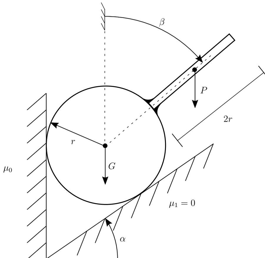
Ein Zylinder (Gewicht  $G$ , Radius  $r$ ) liegt zwischen zwei Wänden. Die linke, vertikale Wand ist rauh - an ihr haftet der Zylinder (Haftkoeffizient  $\mu_0$ ). Die rechte, unten dem Winkel  $\alpha$  gegen die Horizontale geneigte, Wand ist glatt ( $\mu_1 = 0$ ). Am Zylinder ist ein homogener Stab der Länge  $2r$  mit dem Gewicht  $P$  radial angeschweißt. Er ist unter dem Winkel  $\beta$  gegen die Vertikale geneigt.
