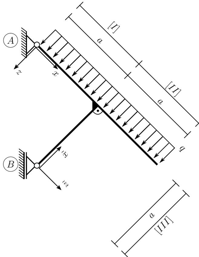
Das dargestellte Tragwerk wird durch die konstante Streckenlast  $q$  belastet. Führen Sie folgende Aufgabenteile durch:
