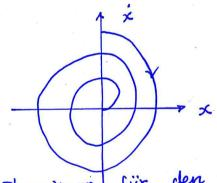
Phasenkurve | für den schwach gedämpften Fall
