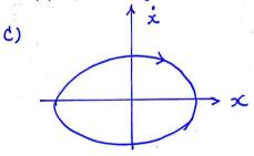
Phasenkurve für den ungedämpfren Fall
