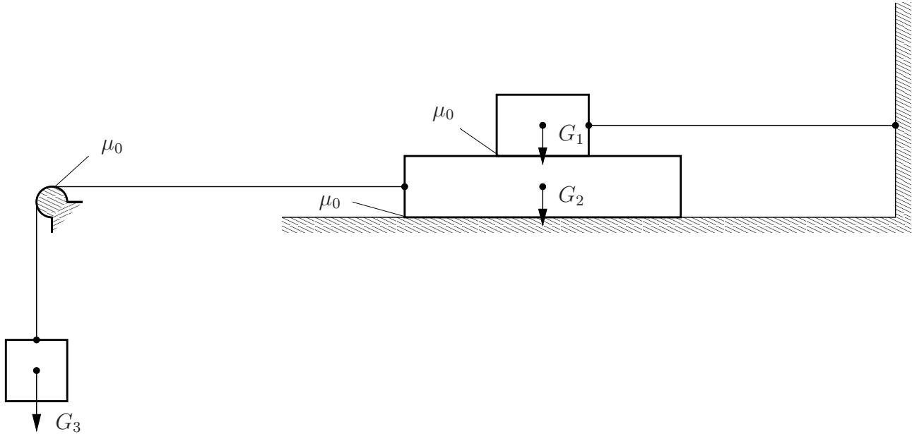
Berechnen Sie für das dargestellte System die maximal mögliche Gewichtskraft  $G_3$ , so dass das System in Ruhe bleibt, wobei die Gewichtskräfte  $G_1$  und  $G_2$  sowie der Haftreibungskoeffizient  $\mu_0$  gegeben sind.
