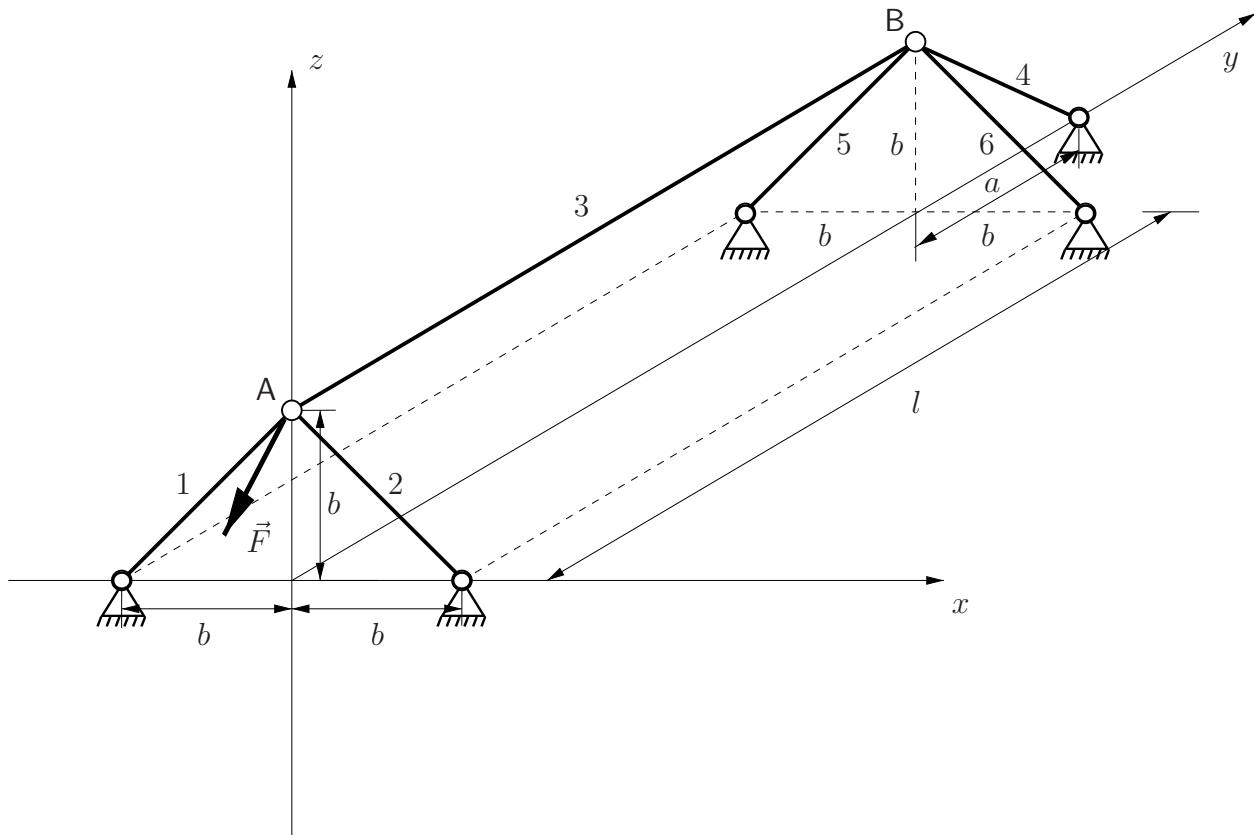
Das aus gelenkig verbundenen Stäben bestehende System (Gerippe eines Zeltes) wird im Punkt A durch eine Seilkraft  $\vec{F} = -F\vec{e}_x - F\vec{e}_y - F\vec{e}_z$  belastet.
