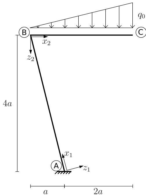
Die oben dargestellte abgeschrägte Tribünenüberdachung wird durch die skizzierte linear verteilte Last
