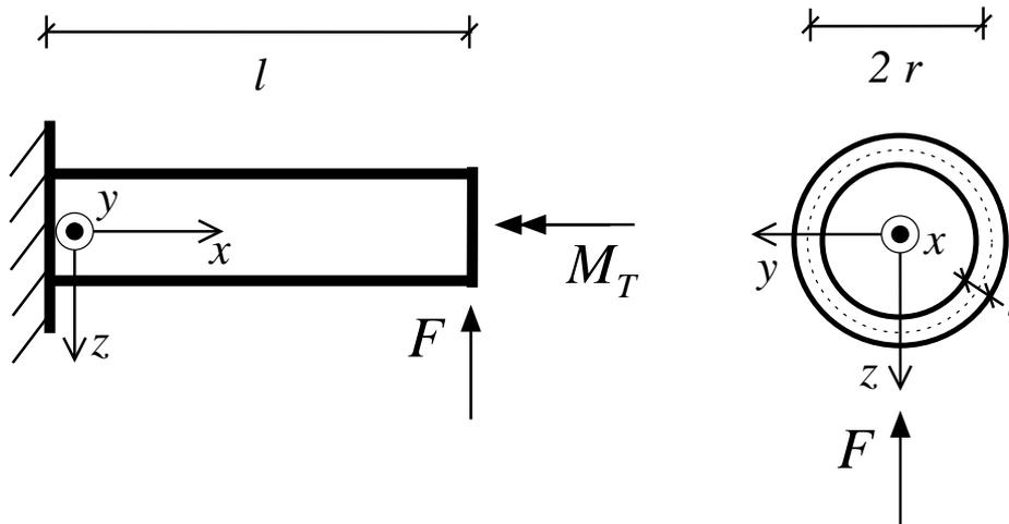
Ein dünnwandiges Rohr (Länge  $l$ , mittlerer Radius  $r$ , Dicke  $t \ll r$ ) ist am linken Rand eingespannt und wird am rechten Rand durch eine Kraft  $F$  sowie ein Torsionsmoment  $M_T$  belastet.
