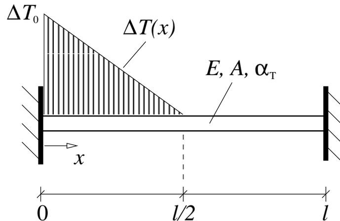
Ein homogener Stab (Länge  $l$ , Elastizitätsmodul  $E$ , Querschnitt  $A$ , thermischer Ausdehnungskoeffizient  $\alpha_T$ ) sei zwischen zwei starren Wänden gelagert. Ausgehend vom unbelasteten Zustand werde der Stab wie skizziert im Bereich  $0 \leq x \leq l/2$  einer linear veränderlichen Temperaturänderung  $\Delta T(x)$  ausgesetzt.
