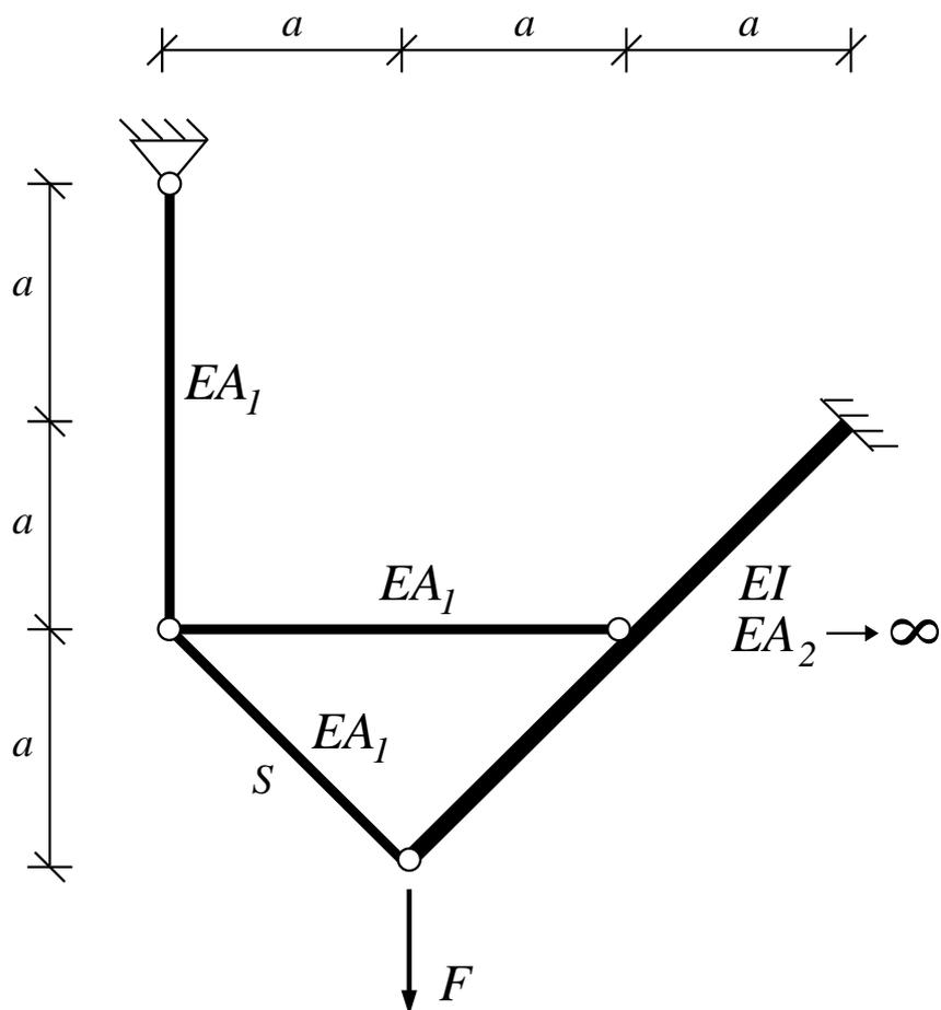
Bestimmen Sie die Kraft in Stab  $S$  infolge der angegebenen Belastung mit dem Prinzip der virtuellen Kräfte bzw. dem Arbeitssatz.
