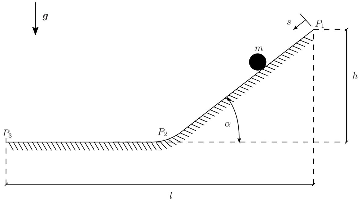
Eine Punktmasse  $m$  rutscht eine schiefe Ebene mit dem Neigungswinkel  $\alpha$  hinunter. Nach stoßfreier Umlenkung in  $P_2$  rutscht sie horizontal weiter. Die Bewegung beginnt ohne Anfangsgeschwindigkeit bei  $P_1$  und ist reibungsfrei.
