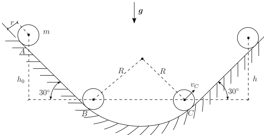
Eine homogene Walze (Masse  $m$ , Radius  $r$ ) wird aus der Ruhe losgelassen und beginnt unter dem Einfluss des Schwerfeldes auf der rauhen Bahn  $AC$  nach rechts zu rollen.
