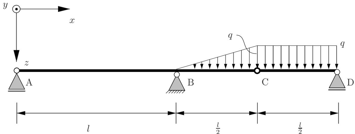
Das dargestellte System wird in Bereich  $B - C$  durch eine linear verlaufende Streckenlast sowie in Bereich  $C - D$  durch eine konstante Streckenlast  $q$  belastet.
