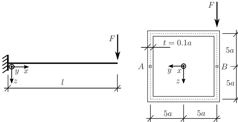
Ein Kragträger der Länge  $l$  besitzt den in der Zeichnung rechts dargestellten Querschnitt und wird durch eine Einzellast  $F$  belastet. Bearbeiten Sie folgende Teilaufgaben:
