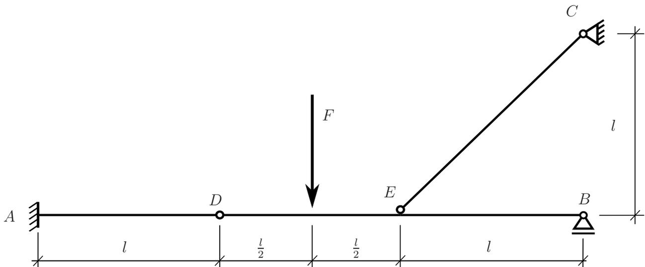
Zwei Balken ( Biegesteifigkeit  $EI$  , Dehnsteifigkeit  $EA_1$  ) sind im Punkt  $D$  durch ein Gelenk miteinander verbunden und werden in Punkt  $A$  und  $B$  gemäß Zeichnung gelagert. In Punkt  $E$  wird ein Stab ( Dehnsteifigkeit  $EA_2$  ) wie dargestellt angebracht. Das Tragwerk wird durch eine Einzellast  $F$  belastet.
