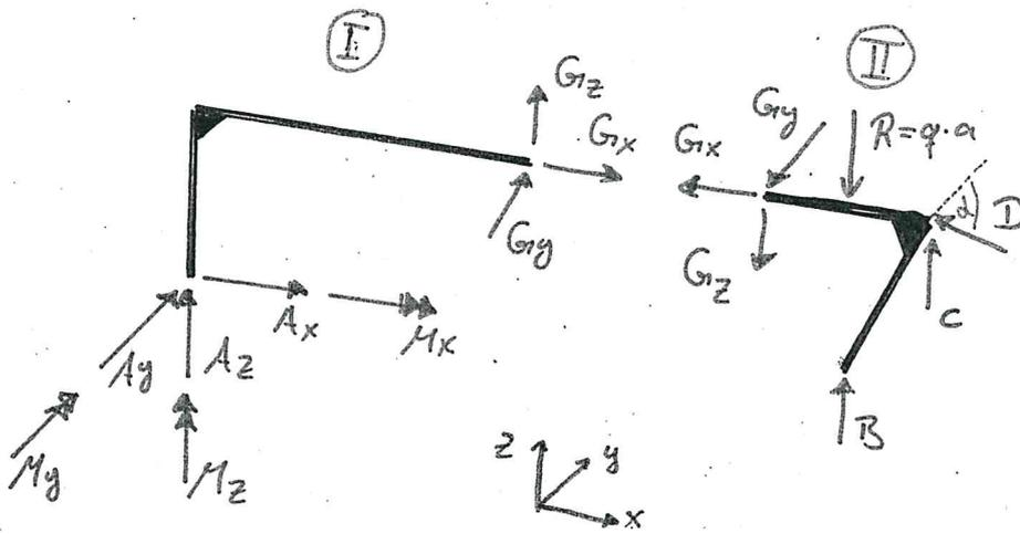
a) • Formel  $a+g = \underbrace{6 \cdot n}_{\text{3D-Fall}}$  mit  $a=6$  in  $A + 1B + 1C + 1D = 9$
