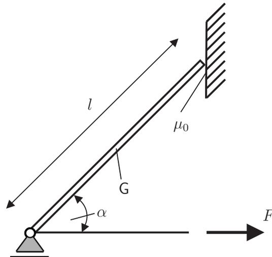
Ein Stab der Länge  $l$  und Gewicht  $G$  lehnt unter dem Winkel  $\alpha$  gegen eine raue Wand. Am unteren Ende wird er durch ein Seil gehalten, das durch die horizontale Kraft  $F$  auf Zug belastet wird.
