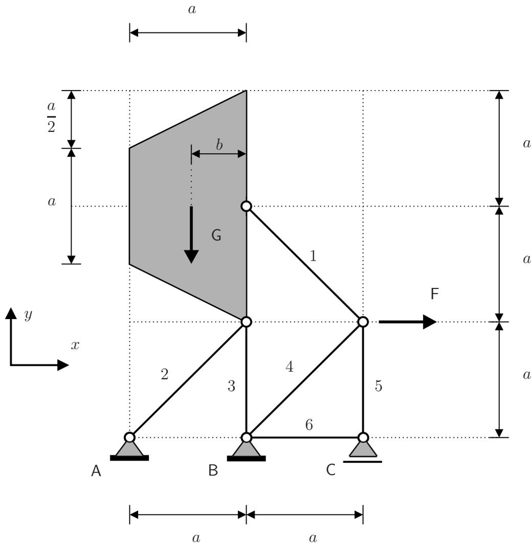
Das dargestellte Tragwerk wird durch eine Kraft  $F$  und durch die Gewichtskraft  $G$  (im Schwerpunkt des starren Körpers) belastet.
