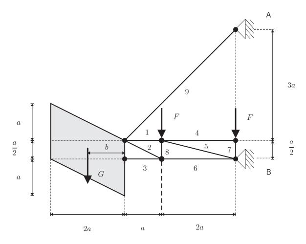
Das dargestellte Tragwerk besteht aus 9 Stäben und einer starren Scheibe. Es wird durch die Kräfte F und durch die Gewichtskraft G (im Schwerpunkt der starren Scheibe) belastet.
