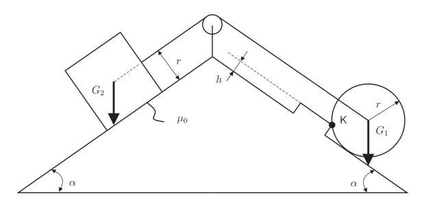
Auf einer doppelseitigen schiefen Ebene mit je einem Neigungswinkel  $\alpha$  ruhen ein Klotz und eine Walze, welche durch ein masseloses Seil miteinander verbunden sind. Dieses Seil wird reibungsfrei über eine Rolle umgelenkt. Die Ebene unter dem Klotz ist rau und führt auf einen Haftungskoeffizienten  $\mu_0$ .
