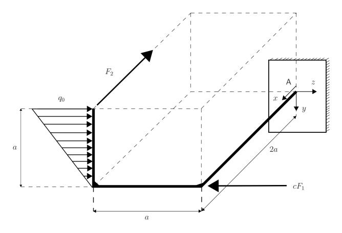
Ein abgewinkelter Träger ist in A eingespannt und wird durch die Einzelkräfte  $cF_1$  und  $F_2$  sowie eine dreiecksförmige Streckenlast belastet. Hierbei kennzeichnet c den Lastvergrößerungsfaktor für die Einzelkraft  $F_1$ .
