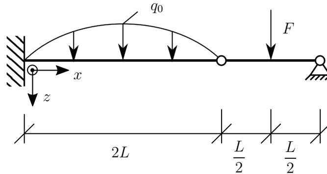
Der dargestellte Balken wird durch die sinusförmige Streckenlast  $q(x)$  mit dem Maximalwert  $q_0$  im Bereich  $0 \leq x \leq 2L$  sowie der Einzellast  $F$  bei  $x = \frac{5}{2}L$  belastet.
