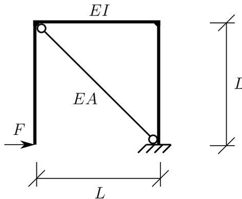
b) Berechnen Sie die Kraft im Stab.
