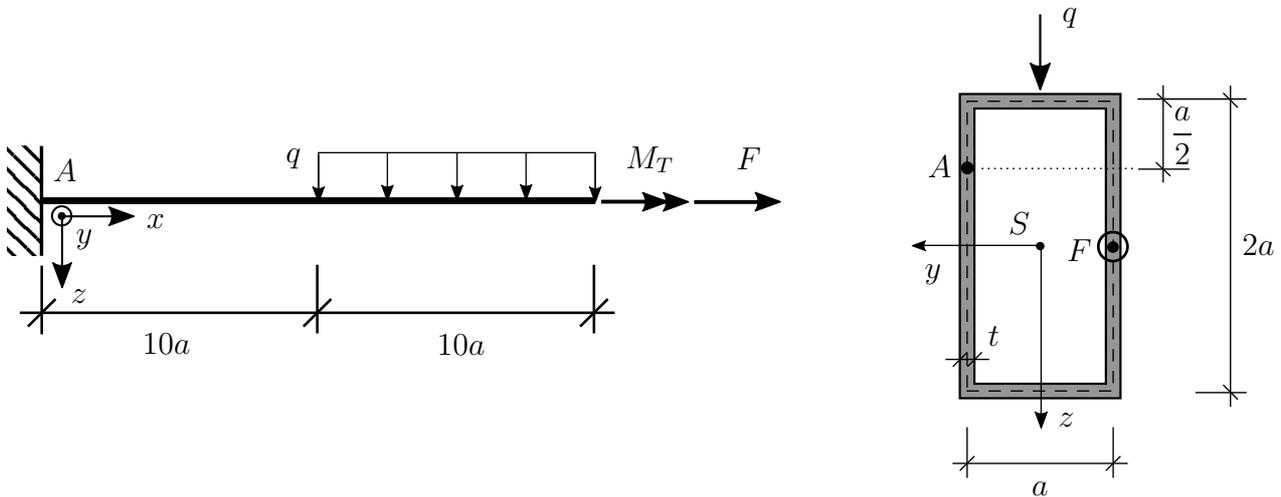
Der dargestellte Kragarm der Länge  $20a$  hat den rechts dargestellten rechteckigen Hohlquerschnitt mit Wandstärke  $t$  und Schubmodul  $G$ . Das System wird durch ein Torsionsmoment  $M_T$ , eine Einzellast  $F$  und eine Streckenlast  $q$  wie dargestellt belastet.
