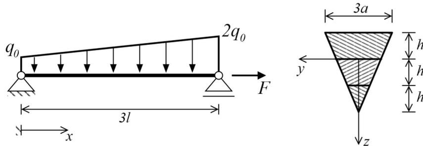
Der Querschnitt (Höhe  $3h$ ) des oben dargestellten Einfeldträgers besteht aus drei zusammengeklebten Balken der Höhe  $h$ . Für die skizzierte Belastung sind die gegebenen Schnittgrößenverläufe zu verwenden:
