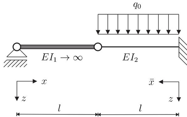
Ein aus zwei Balken mit den Biegesteifigkeiten  $EI_1 \rightarrow \infty$  und  $EI_2$  zusammengesetztes Tragwerk wird durch die Linienlast  $q_0$  beansprucht.
