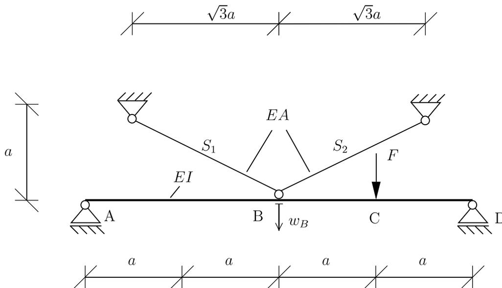
Das oben dargestellte System besteht aus einem Balken und zwei Dehnstäben, welches im Punkt C durch eine Einzelkraft  $F$  belastet wird.
