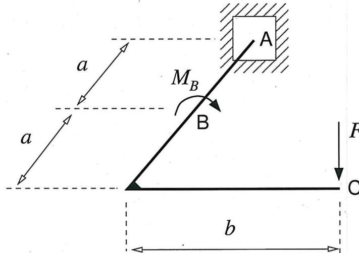
Der im Punkt A eingespannte Rahmen wird wie skizziert im Punkt B durch ein Einzelmoment  $M_B$  und im Punkt C durch eine Einzelkraft  $F$  belastet.
