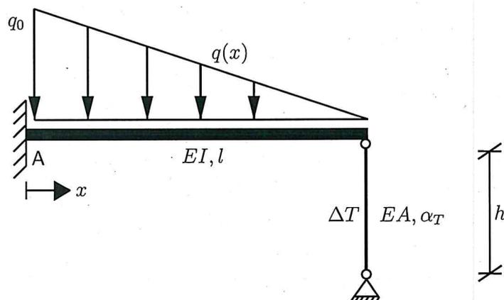
Ein an der Stelle A eingespannter Balken der Länge  $l$  sei zusätzlich durch einen thermoelastischen Stab gestützt und durch eine linear veränderliche Streckenlast  $q(x)$  belastet. Die unbelastete Länge des Stabes sei  $h$ .
