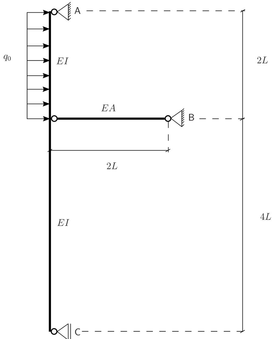
Das dargestellte Tragwerk wird durch eine gleichmäßige Streckenlast  $q_0$  belastet.
