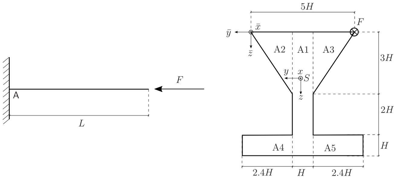
Der dargestellte Kragarm ist in A eingespannt und wird durch eine exzentrisch angreifende Einzelkraft  $F$  belastet. Der Querschnitt des Kragarms lässt sich in ein großes Rechteck (A1), in zwei Dreiecke (A2,A3) und in zwei kleine Rechtecke (A4,A5) zerlegen.
