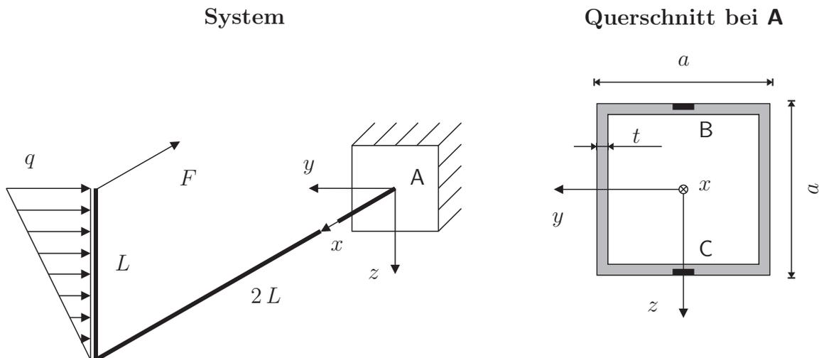
Der dargestellte Kragarm ist in A eingespannt und wird durch eine Streckenlast  $q$  in negativer  $y$ -Richtung sowie eine Einzellast  $F$  in negativer  $x$ -Richtung belastet.
