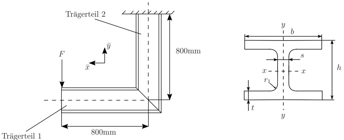
Das skizzierte Tragwerk in L-förmiger Anordnung aus zwei warmgewalzten I-Trägern nach DIN 1025 T2 (breite I-Träger, Kurzzeichen IPB140, siehe Tabelle) wird in der dargestellten Weise mit einer Kraft  $F = 45\text{kN}$  belastet.
