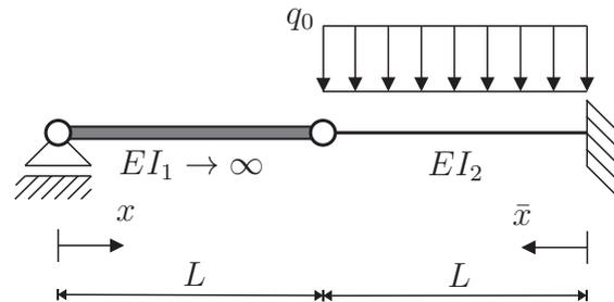
Ein aus zwei Balken mit den Biegesteifigkeiten  $EI_1 \rightarrow \infty$  und  $EI_2$  zusammengesetztes Tragwerk wird durch eine Linienlast  $q_0$  beansprucht.
