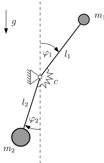
Gegeben sei oben abgebildetes System aus zwei Massen  $m_1$  und  $m_2$ , die an zwei masselosen Stangen der Längen  $l_1$  und  $l_2$  drehbar gelagert sind. Die Stangen sind mit einer Drehfeder der Steifigkeit  $c$  verbunden. Für  $\varphi_1 = \varphi_2 = 0$  ist die Feder entspannt. Es wirke die Erdbeschleunigung  $g$ .
