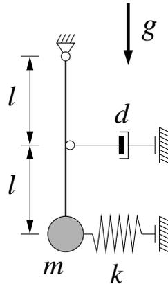
An einer masselosen Stange der Länge  $2l$  ist eine Punktmasse  $m$  befestigt.
