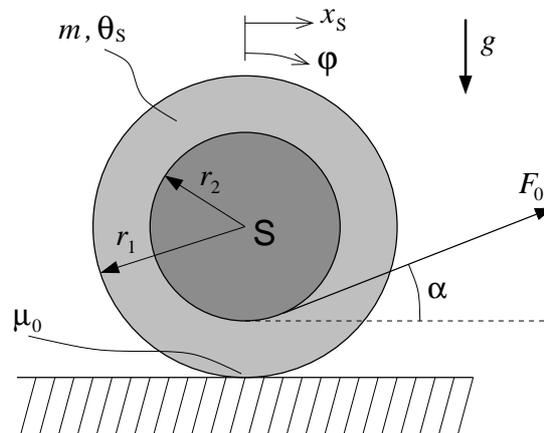
Eine auf einer rauhen Ebene ruhende Seiltrommel (Masse  $m$ , Massenträgheitsmoment  $\theta_S$ ) wird in Bewegung gesetzt, indem am Seil unter dem Winkel  $\alpha$  mit der konstanten Kraft  $F_0$  gezogen wird.
