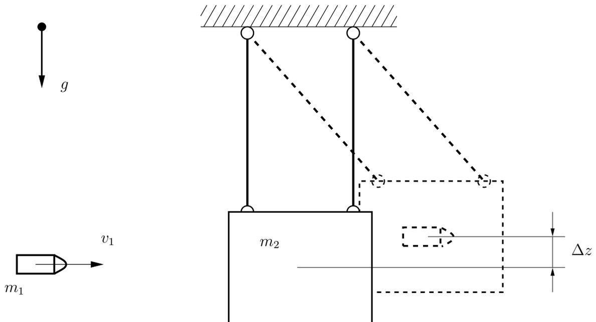
Zur Messung der Geschwindigkeit eines Geschosses ( $m_1$ ) wird das in der oberen Abbildung dargestellte ballistische Pendel verwendet. Das Geschoss dringt mit einer Geschwindigkeit  $v_1$  in das Pendel ( $m_2$ ) ein und bleibt stecken (vollplastischer Stoß). Dabei bewegt sich das System um eine Höhe  $\Delta z$  nach oben. Aus dieser Höhendifferenz soll nun die Geschwindigkeit ( $v_1$ ) ermittelt werden.
