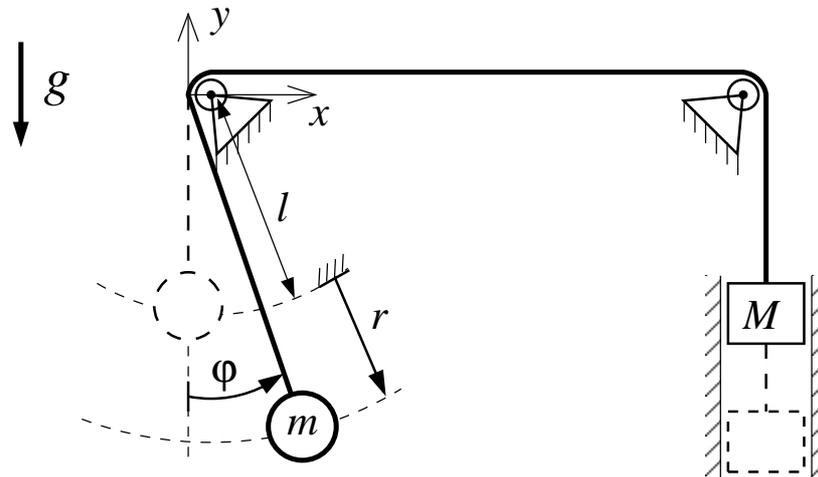
Das oben abgebildete System bestehend aus zwei Massen  $m$  und  $M$ , die über ein masseloses starres Seil verbunden sind, besitzt zwei Freiheitsgrade. Das Seil ist reibungsfrei über zwei Rollen geführt.
