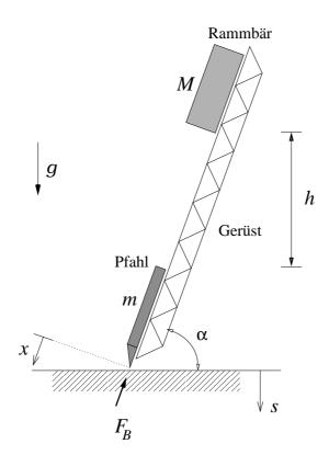
Mit einem Rammbär (Masse M) wird ein Pfahl (Masse m) unter einem Winkel  $\alpha$  in den Boden gerammt. Hierbei wird der Bär aus der Höhe h losgelassen. Der anschließende Stoß erfolgt mit der Stoßzahl e, wobei für die nachfolgende Bewegung angenommen werden kann, dass keine weiteren Stöße erfolgen.
