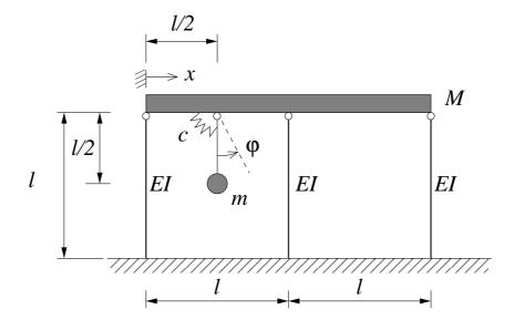
Das dargestellte System eines Rahmens mit einem eingehängten Pendel soll auf das Schwingungsverhalten für kleine Auslenkungen untersucht werden. Der Rahmen besteht aus einem Riegel der Masse M und drei masselosen Stützen, die an einem Ende gelenkig verbunden und am anderen Ende eingespannt sind. Das Pendel besteht aus einer masselosen starren Stange der Länge l/2, einer Punktmasse m und einer Drehfeder der Steifigkeit c.
