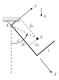
Ein Winkel vom Gewicht G=mg besteht aus zwei dünnen homogenen Stäben. Er ist in A durch eine senkrecht zur Zeichenebene stehende Achse gelagert.
