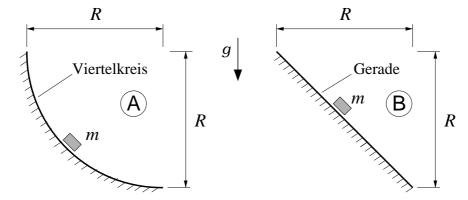
Zwei gleich schwere Massepunkte (m) gleiten aus der Ruhe heraus reibungsfrei zwei Bahnen unterschiedlicher Geometrie hinab. Berechnen Sie
