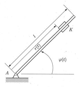
Eine Stange der Länge l rotiert gemäß dem Zeitgesetz  $\varphi(t) = \lambda t^2$  um den Punkt A. Auf der Stange bewegt sich ein Punkt K gemäß dem Gesetz  $r(t) = l(1 - \lambda t^2)$ .
