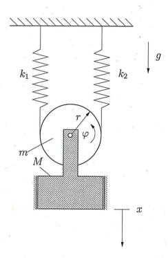
Das skizzierte System bestehend aus einer homogenen Rolle (Radius r, Masse m) und Nutzlast M sei über ein Seil und zwei Federn aufgehängt. Zwischen Rolle und Seil soll kein Gleiten stattfinden. Wählen Sie  $\varphi$  und x als verallgemeinerte Koordinaten des Systems. Im Gleichgewichtszustand soll gelten: x=0 und  $\varphi=0$ .
