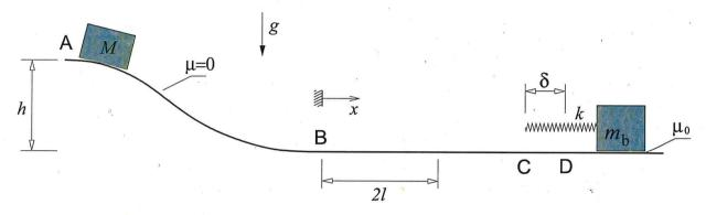
Zum Rangieren von Eisenbahnwagen wird ein Ablaufberg eingesetzt. Ein Wagen der Masse M hat in Punkt A die Anfangsgeschwindigkeit  $v_A$ . Er fährt den Berg der Höhe h hinunter und wird dann auf einer Strecke 2l (gemessen ab Punkt B) mit einer Kraft
