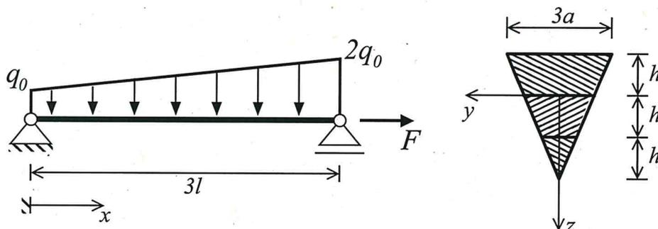
Für das dargestellte System wird ein aus drei verleimten Balken der Höhe  $h$  zusammengesetztes Querschnittsprofil verwendet. Für die skizzierte Belastung seien die Schnittgrößenverläufe wie folgt bereits ermittelt worden:
