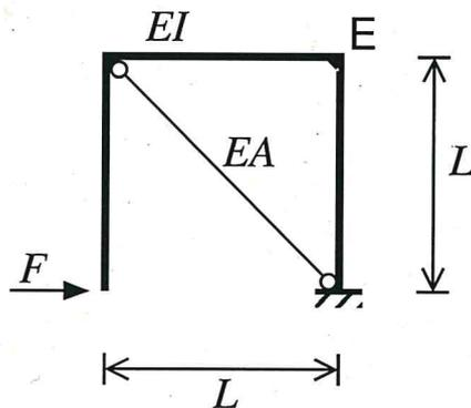
b) Berechnen Sie die Kraft im Stab.
