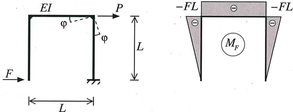
Für obiges System ist der Momentenverlauf  $M_F$  infolge der Last  $F$  gegeben. Die Dehnsteifigkeit im Balken ist zu vernachlässigen.
