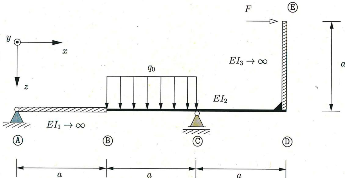
Das dargestellte System wird durch eine konstante Streckenlast  $q_0$  und eine Kraft  $F = q_0 a$  belastet. Die Abschnitte (A) – (B) und (D) – (E) sind als biegestarr anzunehmen, der Bereich (B) – (D) besitzt die Biegesteifigkeit  $EI_2$ .
