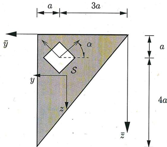
Der skizzierte Querschnitt eines rechtwinkligen Dreiecks enthält eine quadratische Aussparung der Kantenlänge  $a$  und der Neigung  $\alpha$ .
