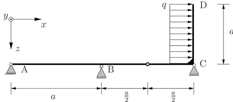
Das dargestellte System wird durch eine konstante Streckenlast  $q$  belastet.
