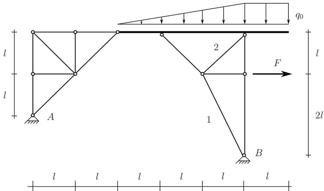
Das oben dargestellte Tragwerk wird durch eine Streckenlast und eine Einzelkraft beansprucht. Bearbeiten Sie folgende Teilaufgaben:
