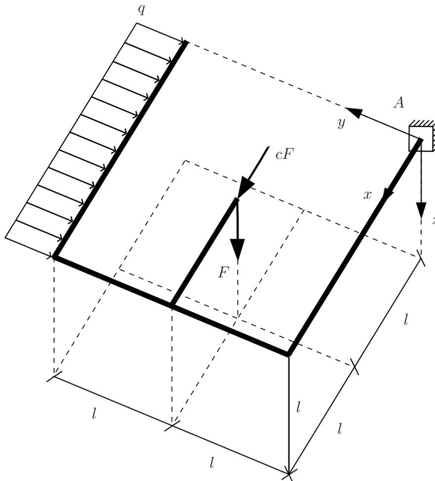
Der rechtwinklige starre Rahmen wird in Punkt  $A$  eingespannt. Die Belastung ist der Darstellung zu entnehmen.
