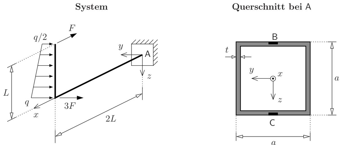
Der dargestellte Kragarm ist in A eingespannt und wird durch eine Streckenlast  $q$  und eine Einzellast  $3F$  in negativer  $y$ -Richtung sowie eine Einzellast  $F$  in negativer  $x$ -Richtung belastet.
