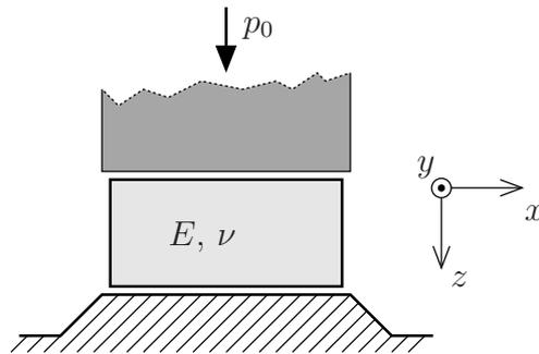
Ein homogener linear-elastischer Quader ( $E, \nu$ ) wird einem Druck  $p_0$  in  $z$ -Richtung ausgesetzt. Aufgrund der geringen Höhe des Quaders kann davon ausgegangen werden, dass ein homogener (ortsunabhängiger) Spannungs- bzw. Verzerrungszustand herrscht.
