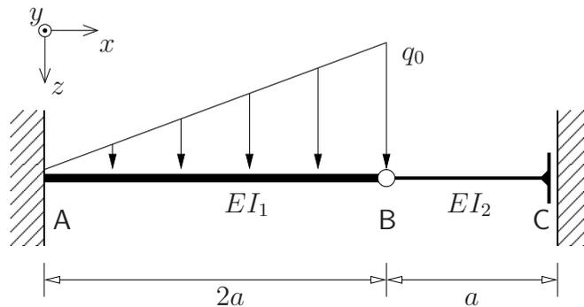
Der oben dargestellte Zweifeldträger mit Gelenk ist einseitig durch eine lineare Streckenlast  $q(x)$  belastet.
