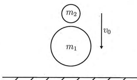
Zwei Kugeln (Massenpunkte)  $m_1$  und  $m_2$  fallen wie skizziert in geringem Abstand unmittelbar hintereinander zu Boden, wo sie mit gleicher Geschwindigkeit  $v_0$  ankommen. Dort kommt es zunächst zum Stoß zwischen  $m_1$  und dem Boden und direkt im Anschluss zum Stoß zwischen den beiden Massen. Alle Stöße seien rein elastisch.
