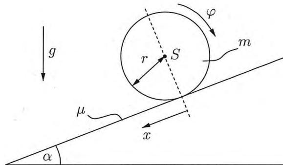
Eine anfangs mit der Winkelgeschwindigkeit  $\dot{\varphi}(t=0) = \omega_0 > 0$  rotierende homogene Walze wird zum Zeitpunkt  $t = 0$  mit der Schwerpunkts­geschwindigkeit  $\dot{x}(t=0) = 0$  auf einer rauhen schiefen Ebene (Reibungskoeffizient  $\mu$ , Neigungswinkel  $\alpha$ ) abgesetzt.
