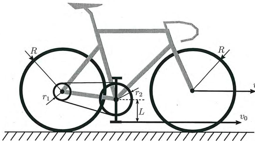
An dem momentan nach unten ragenden Pedal eines Fahrrades sei wie skizziert eine Schnur befestigt, die mit der Geschwindigkeit  $v_0$  nach rechts gezogen wird. Ermitteln Sie unter der Voraussetzung, dass die Räder auf der Unterlage rollen und das Fahrrad keinen Freilauf besitzt, die Geschwindigkeit  $v$  des Fahrrades.
