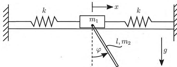
An einer Masse  $m_1$ , die zwischen zwei Federn (Federsteifigkeit  $k$ ) horizontal reibungsfrei gleiten kann, ist ein reibungsfrei gelagerter homogener Stab der Länge  $l$  und der Masse  $m_2$  befestigt.
