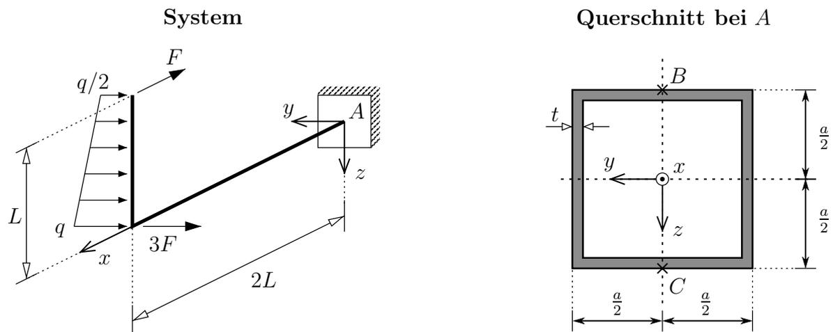
Der dargestellte Kragarm ist in  $A$  eingespannt und wird durch eine Streckenlast  $q$  und eine Einzellast  $3F$  in negativer  $y$ -Richtung sowie eine Einzellast  $F$  in negativer  $x$ -Richtung belastet.
