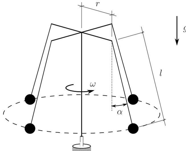
In der Abbildung ist ein rotierendes Karussell skizziert. Sitz und Fahrgast können als Massenpunkt  $m$  angesehen werden. Das Karussell rotiert mit konstanter Winkelgeschwindigkeit  $\omega$ . Wie groß ist die Winkelgeschwindigkeit  $\omega$  sowie die Bahngeschwindigkeit  $v$  der Fahrgäste auf dem Karussell, wenn die Halteseile (Länge  $l$ ) um den Winkel  $\alpha$  gegen die Senkrechte geneigt sind?
