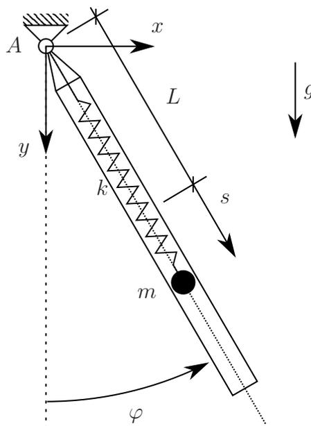
In der oben dargestellten Vorrichtung wird eine Kugel (Punktmasse  $m$ ) an einer Feder (Federsteifigkeit  $k$ ) in einem masselosen Rohr geführt. Die Feder hat im entspannten Zustand die Länge  $L$ . Das Rohr ist im Punkt  $A$  aufgehängt und kann sich in der Zeichenebene um den Winkel  $\varphi$  frei bewegen. Die Koordinate  $s$  gibt die Bewegung der Masse  $m$  im Rohr bezogen auf die entspannte Länge  $L$  an.
