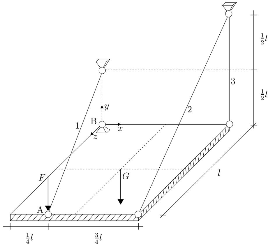
Das dargestellte Vordach wird durch drei Seile abgespannt und ist im Punkt B gelenkig gelagert. Das Vordach besteht aus einer quadratischen, homogenen Platte und wird durch sein Eigengewicht  $G$  sowie einer am Knoten A angreifenden Gewichtskraft  $F$  eines Blumentopfes belastet.
