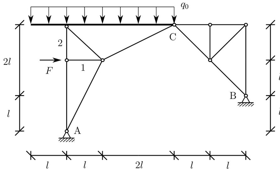
Das dargestellte Tragwerk wird durch eine konstante Streckenlast  $q_0$  und eine Last  $F$  belastet.
