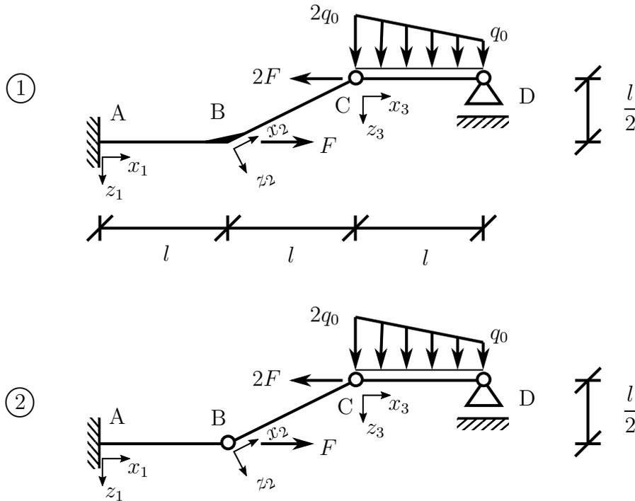
Gegeben sind zwei unterschiedliche Tragwerke ① und ②, die jeweils durch eine Streckenlast sowie zwei Einzelkräfte belastet werden.
