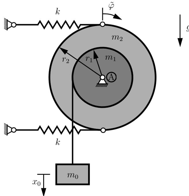
Zwei homogene Kreisscheiben (Radius  $r_1$  und  $r_2$ , Massen  $m_1$  und  $m_2$ ) sind fest miteinander verbunden und reibungsfrei drehbar in Punkt A gelagert. An der großen Scheibe sind zwei Federn (Federsteifigkeit  $k$ ) so angeschlossen, dass sich diese nur horizontal verlängern oder verkürzen können. An der kleinen Scheibe hängt eine Masse  $m_0$  an einem masselosen Seil, das auf der kleinen Kreisscheibe aufgewickelt ist.
