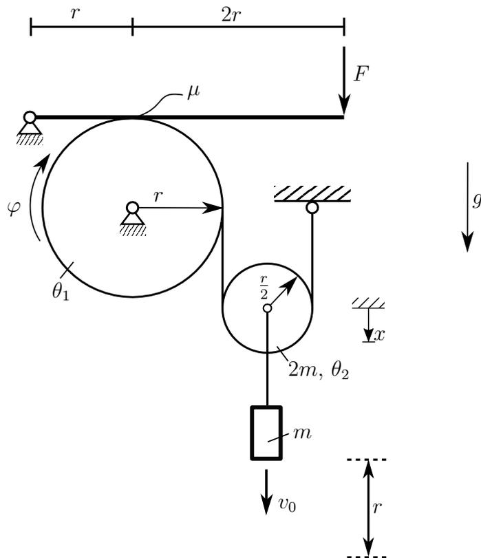
Ein System aus zwei Rollen und einer Punktmasse soll über einen **masselosen** Bremshebel durch die Kraft  $F$  zum Stillstand gebracht werden. Die Rollen sind über ein masseloses Seil verbunden. Zwischen dem Seil und den Rollen liegt Haften vor und zwischen der großen Rolle und dem Bremshebel Reibung mit dem Reibkoeffizienten  $\mu$ . Im Anfangszustand hat die Punktmasse die Geschwindigkeit  $v_0$ .
