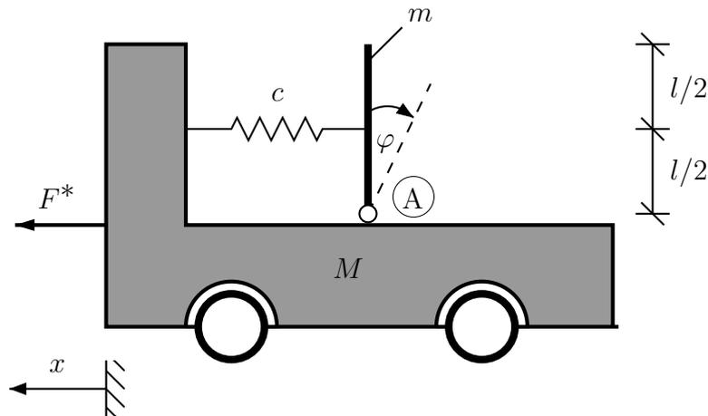
Ein Fahrzeug der Masse  $M$  transportiert ein Fertigbauteil, das in der Ebene als homogener Stab der Masse  $m$  und Länge  $l$  betrachtet werden kann. Der Stab ist im Fußpunkt  $A$  drehbar gelagert und horizontal wie skizziert durch eine Feder der Steifigkeit  $c$  am Fahrzeug abgestützt. Auf das Fahrzeug wirkt eine konstante Antriebskraft  $F^*$ .
