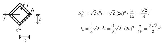
Schubspannung infolge Querkraft in Punkt A
