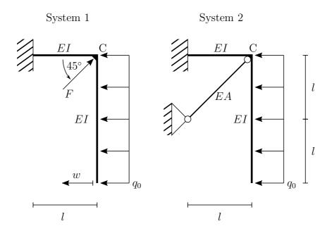
Gegeben ist der abgewinkelte Kragarm mit der Biegesteifigkeit EI. Die Dehnsteifigkeit im Balken soll vernachlässigt werden.
