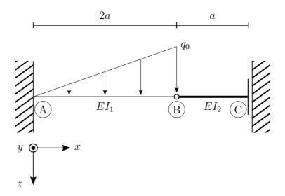
Der oben dargestellte Zweifeldträger mit Gelenk ist einseitig durch eine lineare Streckenlast q(x) belastet.
