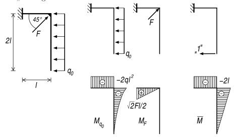
Die Verschiebung wird mit dem Prinzip der virtuellen Kräfte berechnet.
