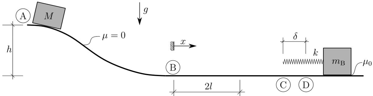
Zum Rangieren von Eisenbahnwagen wird ein Ablaufberg eingesetzt. Ein Wagen der Masse  $M$  hat in Punkt (A) die Anfangsgeschwindigkeit  $v_A$ . Er fährt den Berg der Höhe  $h$  hinunter und wird dann auf einer Strecke  $2l$  (gemessen ab Punkt (B)) mit einer Kraft
