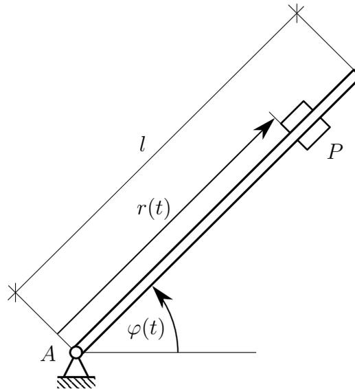
Eine Stange der Länge  $l$  rotiert gemäß dem Gesetz  $\varphi(t) = \lambda t^2$  um den Punkt  $A$ . Auf der Stange bewegt sich ein Punkt  $P$  gemäß dem Gesetz  $r(t) = l(1 - \lambda t^2)$ .
