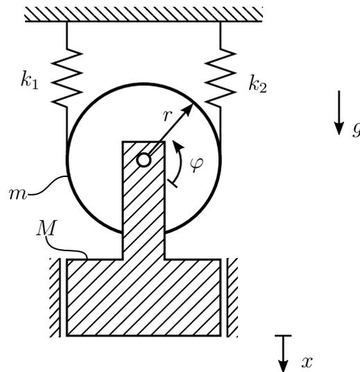
Das dargestellte System besteht aus einer homogenen Rolle (Radius  $r$ , Masse  $m$ ) und einer **gelenkig** angebrachten Nutzlast mit Masse  $M$ . Die Rolle ist über ein Seil mit zwei Federn (Federsteifigkeit  $k_1$  bzw.  $k_2$ ) verbunden, wobei zwischen Rolle und Seil **kein Gleiten** stattfindet. Verwenden Sie zur Bearbeitung der Aufgabe die vorgegebenen Freiheitsgrade  $x$  und  $\varphi$ . Im Gleichgewichtszustand gelte  $x = 0$  und  $\varphi = 0$ .
