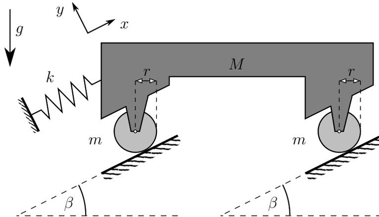
Das abgebildete Fahrzeug der Masse  $M$  bewegt sich auf zwei zylindrischen Walzen (jeweils mit der Masse  $m$  und dem Radius  $r$ ), die auf einer um  $\beta$  geneigten Ebene rollen. Eine ebenfalls um  $\beta$  geneigte Feder der Steifigkeit  $k$  sichert das Fahrzeug.
