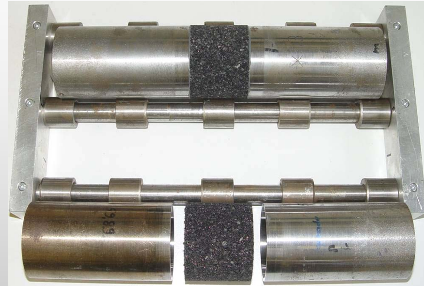
Fügevorrichtung zur Herstellung des Schaumstoffprüfkörpers durch Stumpfkleben
