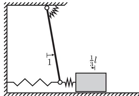
d) Eine Auslenkung der Form  $\varphi = \frac{1}{l}$  und  $x = -\frac{1}{3}$  entspricht einer Auslenkung in der zweiten Eigenform. Somit verläuft die einsetzende Schwingung gemäß
