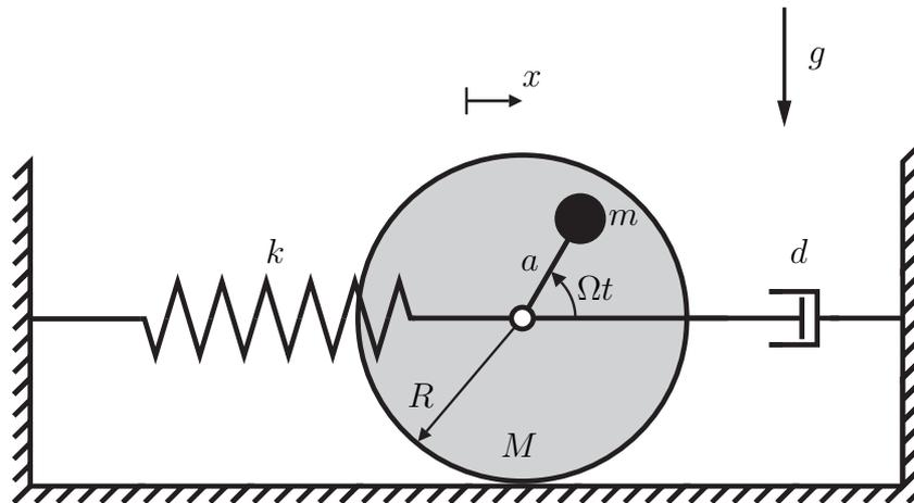
Der dargestellte kreisförmige, starre Körper mit dem Radius  $R$  und der Masse  $M$ , rollt ohne zu gleiten auf einer ebenen Unterlage. Die Position des Körperschwerpunkts wird über die Koordinate  $x$  beschrieben. Im Schwerpunkt ist eine feststehende Achse angebracht, die während der Bewegung des Körpers nicht mitrotiert. Diese Achse ist, wie abgebildet, über eine Feder mit der Federsteifigkeit  $k$  und einen Dämpfer mit der Dämpfungskonstanten  $d$  mit der Umgebung verbunden.
