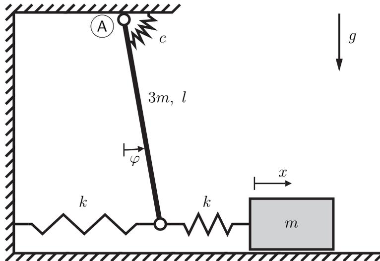
Ein schlanker, starrer Stab der Masse  $3m$  und der Länge  $l$  ist im Punkt  $\textcircled{A}$  gelenkig gelagert und mit einer Drehfeder (Drehfedersteifigkeit  $c$ ) verbunden. Am anderen Ende ist der Stab, wie abgebildet, über zwei Federn (jeweils mit der Federsteifigkeit  $k$ ) mit einer Wand sowie einer reibungsfrei gleitenden Masse  $m$  verbunden.
