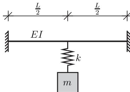
Skizzieren Sie ein Ersatzsystem mit nur einer (Ersatz-)Feder und bestimmen Sie deren Ersatzfedersteifigkeit  $k_{\text{Ers}}$ .
