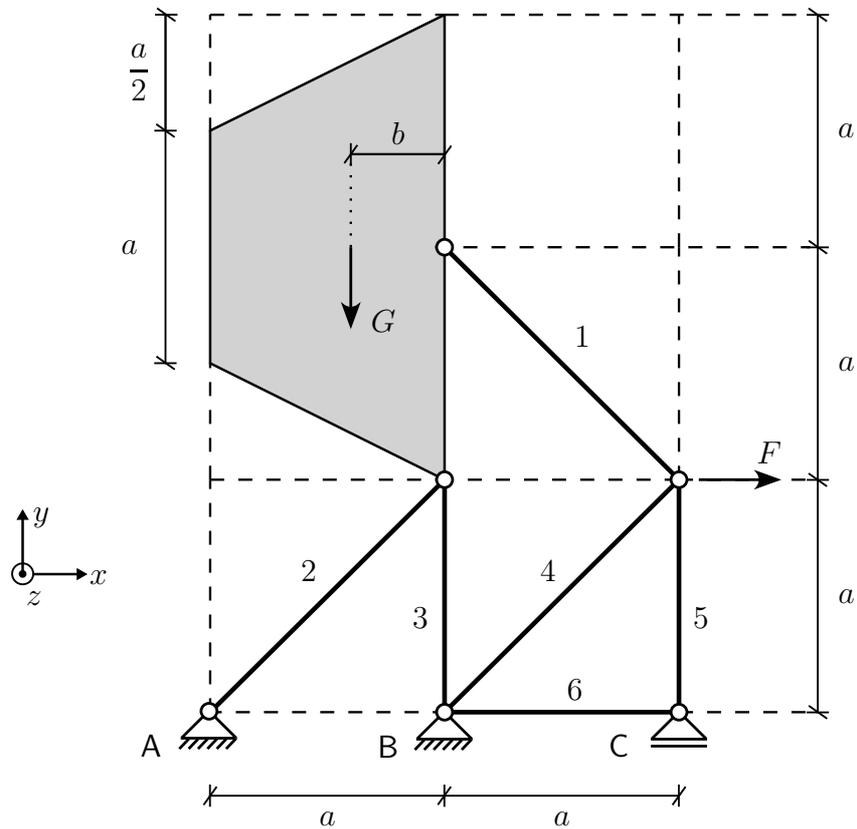
Das dargestellte Tragwerk wird durch eine Kraft  $F$  und durch die Gewichtskraft  $G$  (im Schwerpunkt des starren Körpers) belastet.
