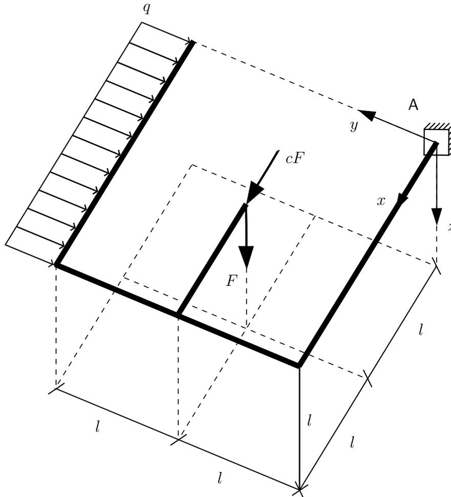
Der im Punkt A eingespannte Rahmen wird wie skizziert belastet.
