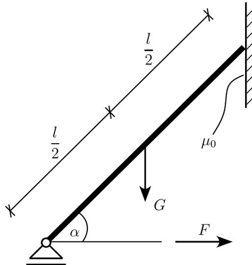
Ein Stab der Länge  $l$  und der Gewichtskraft  $G$  lehnt unter dem Winkel  $\alpha$  gegen eine raue Wand. Am unteren Ende wird er durch ein Seil gehalten, das durch die horizontale Kraft  $F$  auf Zug belastet wird.
